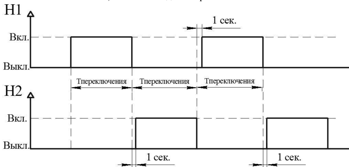
Рисунок 20 – Диаграмма работы БУН в режиме «ПОСМЕННЫЙ»
