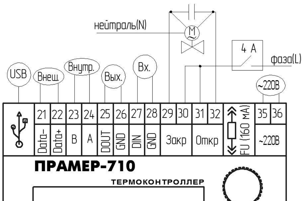
Рисунок 2 – Назначение клемм подключения внешних устройств
